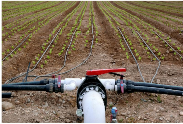
الشكل (5): مكونات شبكة الري بالتنقيط
