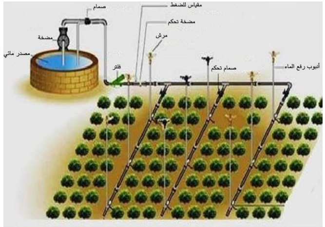
الشكل (7): مكونات شبكة الري بالرذاذ
